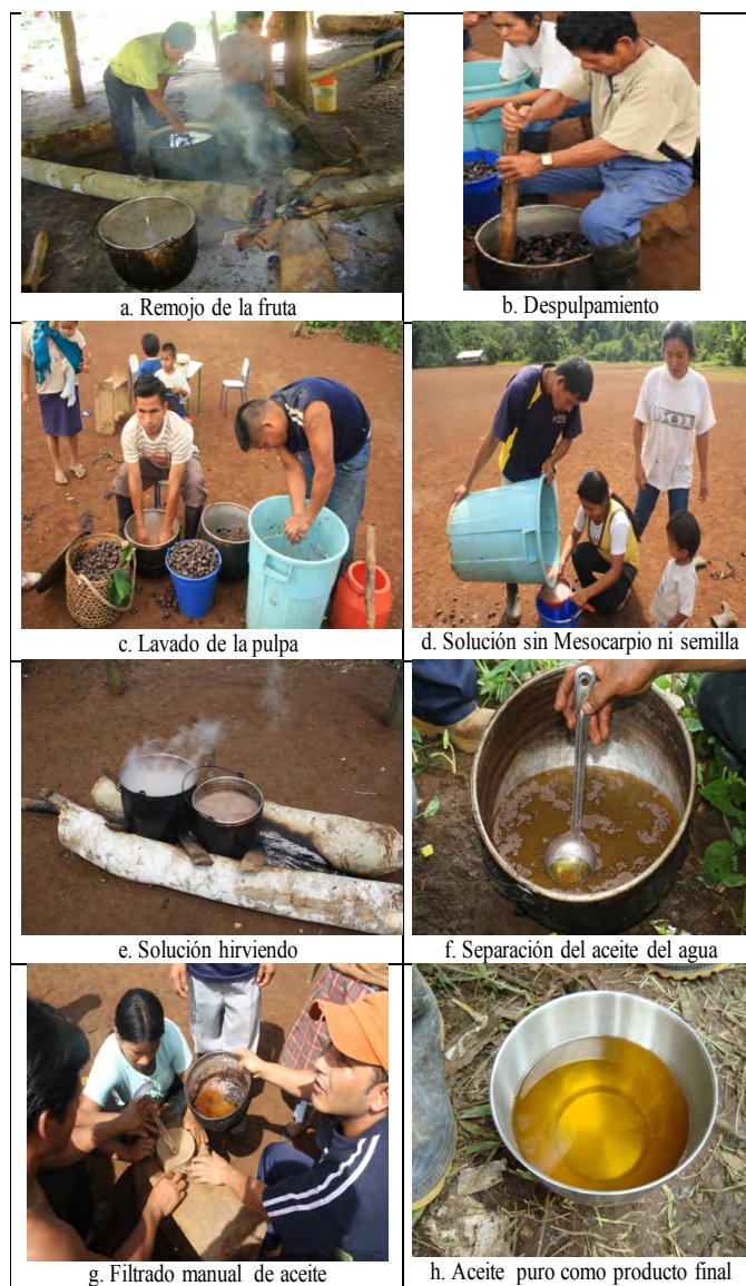
Figura 6. Proceso de extracción tradicional de aceite de Oenocarpus bataua en la comunidad Chiriap
