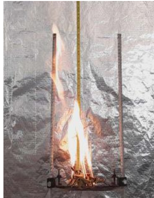
Figura 2. Equipos utilizados para realizar las pruebas de inflamabilidad bajo condiciones de laboratorio.
