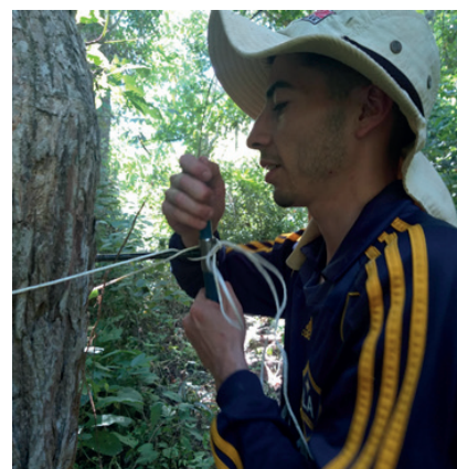
Figura 2. Extracción del núcleo de madera con un barreno de Pressler
