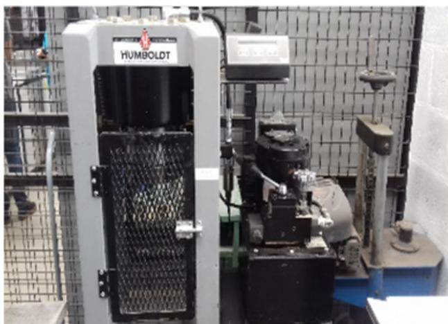
**Fig. 3:** Equipo para ensayos de resistencia a la compresión Humboldt.
