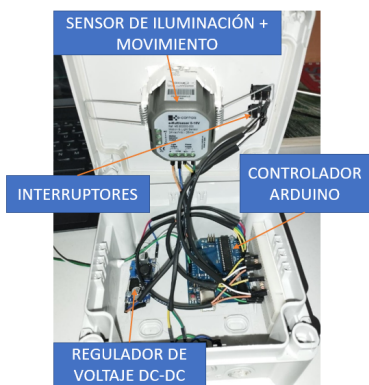
Fig. 14: Conexiones eléctricas del sistema de control.
