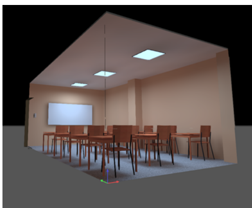
Fig. 5: Configuración de luminarias en el software Dialux.
