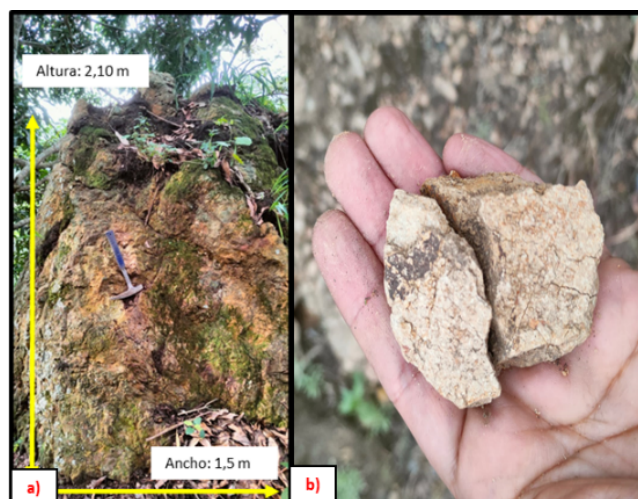
Fig. 9: La figura a) muestra un afloramiento de lutita con grado de alteración media y la figura b) indica una fracción de roca del mismo punto de muestreo
