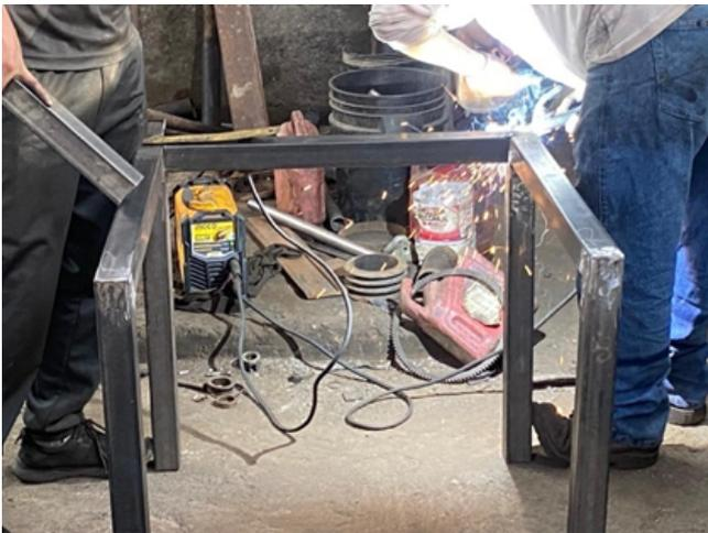
**Fig. 12:** Diseño de mesa cuadrada que servirá como soporte para el molino
