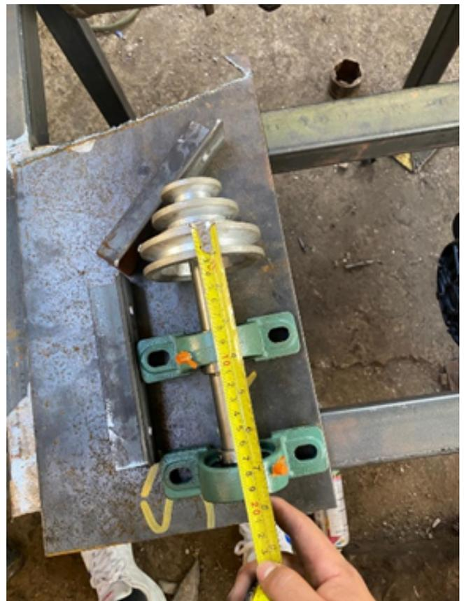
**Fig. 14:** Toma de medidas para colocación de segunda polea
