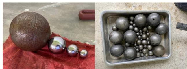
**Fig. 25:** Bolas de molienda correctamente graduadas utilizadas dentro del molino
