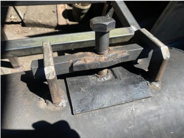
**Fig. 11:** Tapa y seguro del cilindro
