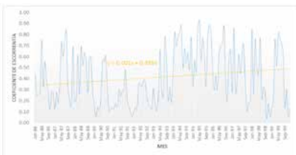
Figura 2. Serie temporal de coeficientes de escorrentía reales de la parte alta de la cuenca Catamayo.
