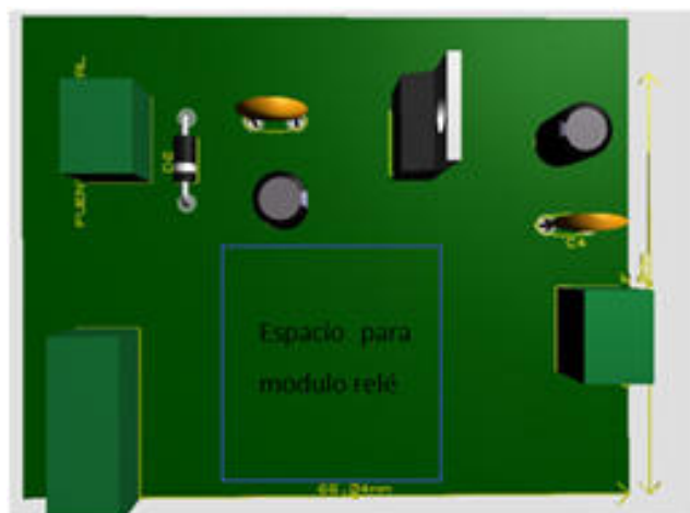
Fig. 7: Placa PCB de circuito de control y activación.
