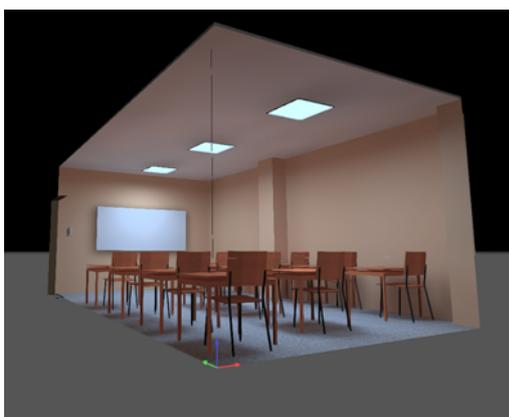
Fig. 5: Configuración de luminarias en el software Dialux.
