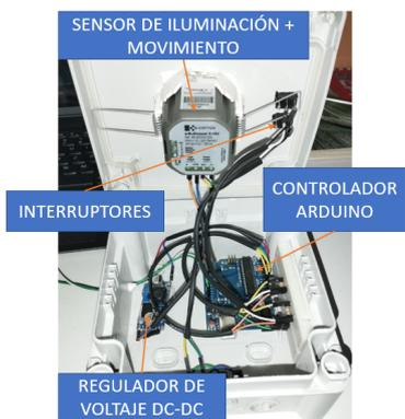
**Fig. 14:** Conexiones eléctricas del sistema de control.
