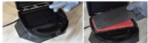
Fig. 8: Proceso de conformado de las placas de PEAD, Foto izq. Base para molde de placa. Foto der. Contrapeso de placa de acero.
