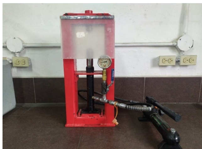
Fig. 4: Equipo para ensayos de carga puntual.
